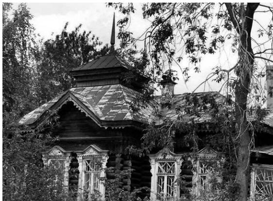
Жилой деревянный дом служащего завода (ул. Луначарского, 1) *(на фото)* относится к постройкам 1915-1916 годов. Он также построен по чертежам проектного отдела металлургического завода. Для украшения досок-причелин использована геометрическая резьба. Под лобовой доской по всему периметру дома проложено деревянное кружево. Крыша дома – шатровая. Особенно нарядными являются
